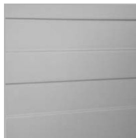
frézování na povrchu křídla v šířce 30 mm u verze B9
